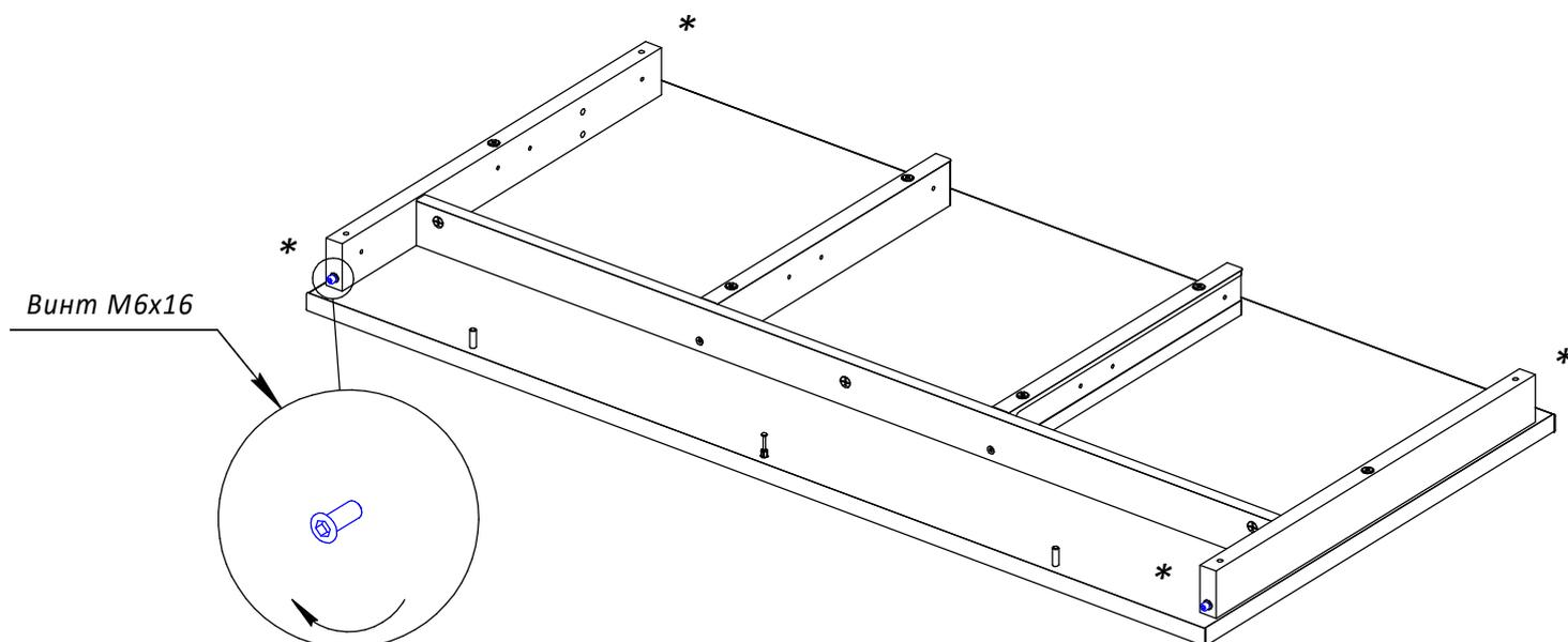
**\* ВИНТ М6х16 ПО ЛИЦЕВОЙ ЧАСТИ ЗАКРУТИТЬ ДО УПОРА, ПОСЛЕ ЧЕГО ВЫКРУТИТЬ НА 2 ОБОРТА!**
